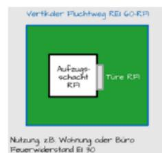
Ob der Liftschacht einen Feuerwiderstand aufweisen muss, hängt unter anderem von der Lage innerhalb des Gebäudes ab. Liegt der Aufzug z.B. vollständig im vertikalen Fluchtweg, ist für die Schachtwände kein Feuerwiderstand gefordert. Anders verhält es sich, wenn der Liftschacht direkt an die Nutzung grenzt.
